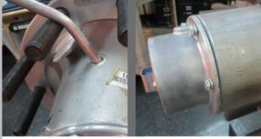
Coloque la tapa de maza, pero no apriete los tornillos para permitir la ventilación durante el llenado. Coloque el lubricante de grasa semifluida a través del orificio de llenado en el barril de la maza.
