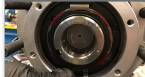
Inserte la pestaña del anillo de resorte de seguridad rojo a través de la tuerca y la arandela alineadas. Extienda el anillo, empujelo sobre la tuerca de husillo dentro de las ranuras mecanizadas. Tenga la precaución de no doblar el anillo de seguridad. Si el anillo está doblado o dañado, reemplácelo con uno nuevo.
