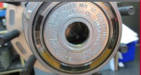
Asegúrese de que la tapa de maza esté llena hasta la marca "nivel de aceite" que se encuentra en la parte frontal de la tapa. Deje que la cantidad de llenado inicial se asiente por 10 minutos. Repita el proceso de llenado hasta que el aceite esté al nivel de la línea de llenado de la tapa de maza.
