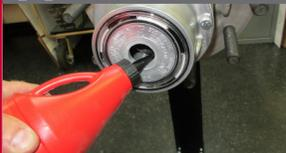
Llene la maza con el aceite a través de la tapa de maza o el orificio de llenado en el barril de la maza.
