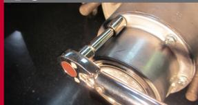
Instale la tapa de maza y ajuste los tornillos con un patrón de estrella y un par de torsión de 12 ft-lb a 18 ft-lb.
