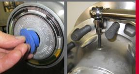
Coloque el tapón de llenado en la tapa de maza o en el barril de la maza. Ajuste el tapón de llenado en el barril de la maza de 20 ft-lb a 25 ft-lb.
