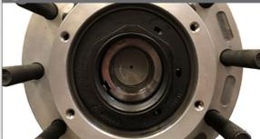
Coloque la maza en el husillo con un movimiento suave y firme. Cuando la rosca de la tuerca enganche con la rosca del husillo, gire la tuerca en sentido horario para enganchar completamente las roscas.
