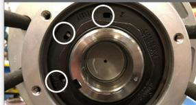
Examine en forma visual los tres orificios en la cara de la tuerca de husillo. Uno de los orificios estará alineado con los orificios de la arandela interna.
