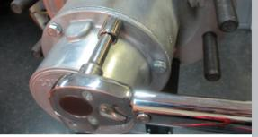
Ajuste los tornillos de la tapa de maza con un patrón de estrella y un par de torsión de 12 ft-lb a 18 ft-lb.
