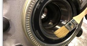
Quite todo el envoltorio, puede incluir anillos de cartón interno y externo y un disco elástico. Lubrique el diámetro interior del sello con el mismo lubricante que utilizará en el extremo de la rueda.
