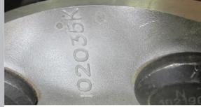
Utilice el número de fundición de la maza y la tabla de grasa semifluida más abajo para determinar el volumen de llenado adecuado.
