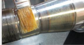
Lubrique los soportes de los baleros en el husillo, o el diámetro interior de los conos del husillo, con una grasa de grado 2 o el lubricante que se utilizará en el extremo de la rueda.
