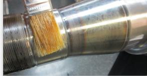
Lubrifiez la course du roulement sur l'axe ou le diamètre intérieur des cônes de roulement avec une graisse de grade 2 ou le lubrifiant qui sera utilisé dans l'extrémité de roue.
