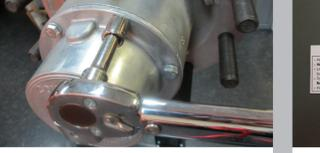
Serrez les boulons du couvre-moyeu en forme d'étoile à un couple de 12 à 18 pi-lb.
