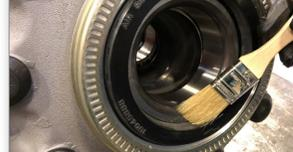
Retirez tout l'emballage, qui peut inclure des anneaux de carton intérieur et extérieur et un disque bungee. Lubrifiez le diamètre intérieur du joint avec le même lubrifiant qui sera utilisé dans l'extrémité de roue.
