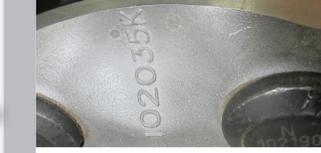
Utilisez le numéro de coulage sur le moyeu et dans le tableau de graisse semi-fluide ci-dessous pour déterminer le bon volume de remplissage.
