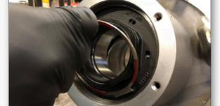
Retirez l'anneau de blocage rouge de l'écrou d'axe. Vérifiez que l'espaceur de roulement est adéquatement aligné. Alignez la clé de la rondelle avec l'encoche de l'axe.
