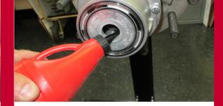
Remplissez le moyeu avec de l'huile dans le couvre-moyeu ou le trou de remplissage du cylindre du moyeu.
