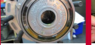
Assurez-vous que le couvre-moyeu est adéquatement rempli jusqu'à la marque de niveau d'huile sur le couvre-moyeu. Allouez 10 minutes pour permettre à l'huile de se stabiliser. Si nécessaire, ajoutez de l'huile jusqu'à la ligne de remplissage du couvre-moyeu.
