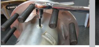
Remettez le bouchon de remplissage et serrez le bouchon à un couple de 20 à 25 lb-pi.
