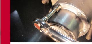
Installez le couvre-moyeu et serrez les boulons en forme d'étoile à un couple de 12 à 18 pi-lb.
