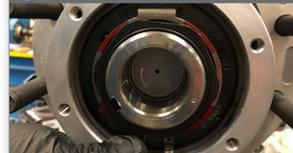
Insérez l'onglet de l'anneau de blocage rouge dans les trous alignés de l'écrou et de la rondelle. Écartez l'anneau et poussez-le par-dessus l'écrou d'axe et dans les rainures machinées. Faites attention de ne pas plier l'anneau de blocage. Si l'anneau est plié ou endommagé, remplacez-le avec un nouvel anneau.
