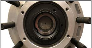
Utilisez un mouvement souple mais ferme pour placer le moyeu sur l'axe. Lorsque les filets de l'écrou sont engagés sur l'axe, tournez l'écrou dans le sens horaire pour engager pleinement les filets.
