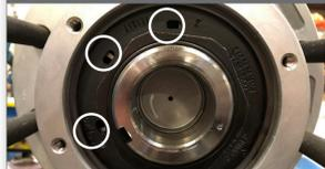
Examinez les trois trous sur la surface de l'écrou d'axe. Un de ces trous devra s'aligner avec les trous de la rondelle interne.
