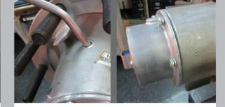
Installez le couvre-moyeu, mais ne serrez pas les boulons pour permettre à l'air de sortir durant le remplissage. Versez la graisse semi-fluide dans le trou de remplissage du cylindre du moyeu.
