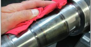
Enlevez tout lubrifiant, protection anticorrosion, matière étrangère ou rouille de surface sur l'axe.
