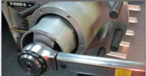
Serrez l'écrou d'axe à un couple de 500 pi-lb. tout en tournant le moyeu.
