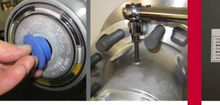
Remettez le bouchon de remplissage du couvre-moyeu ou du cylindre du moyeu. Serrez le bouchon de remplissage du cylindre de moyeu à un couple de 20 à 25 lb-pi.
