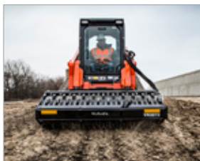
Pour assurer un compactage régulier et constant, le tambour oscille de 15° pour suivre le contour de la surface.
