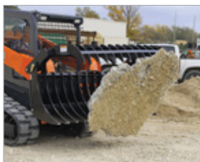
Deux vérins hydrauliques permettent à la mâchoire supérieure de mieux saisir le matériau.
