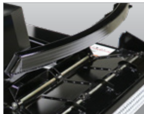
La barre de poussée force les arbres à l'écart de l'opérateur.
